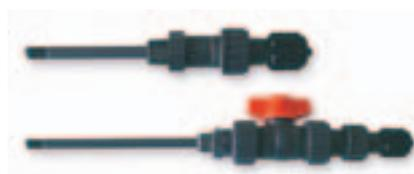
Valvola d'iniezione in PVC, portata MAX 50 lt/h, connessione IN 1/2" g.m., tubo 8x12, tubo 4x6, connessioni Out 1/2" g.m., Max pressione di esercizio 10 bar, tenute FPM (standard) o EPDM (su richiesta), temperatura max del liquido 35°C.
